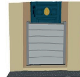
Le batardeau à glissières
