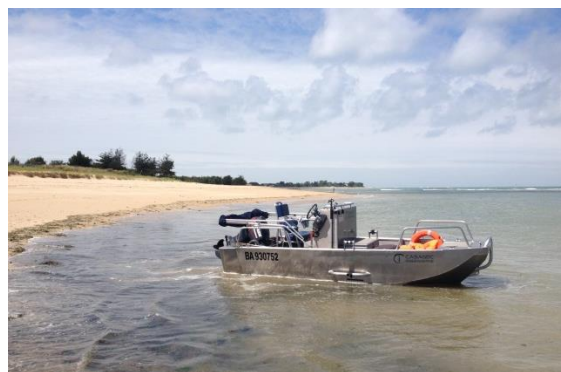
Figure 8. Vedette hydrographique utilisée pour les levés bathymétriques.
