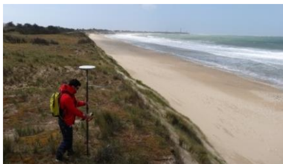
Figure 4. Levé topographique de la dune réalisé au GPS-RTK.
